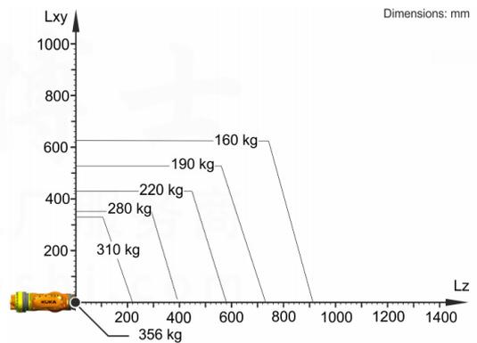
KR 280 R3080 设计用于额定负载能力 280 kg，以便最佳利用机器人的性能和动态性能。通过减小负载间距，也可以使用高达最大负载能力的更高负载。特殊的负载情况必须用 KUKA.Load 进行检查。如果需要详细咨询，请联系 KUKA 支持部。
