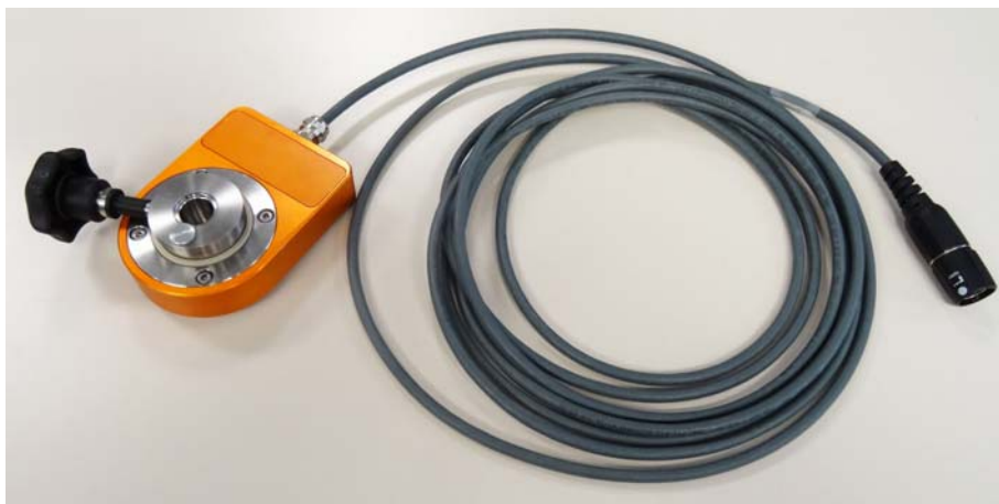
图 2-10: 焊钳 CFS10 的夹紧力传感器
