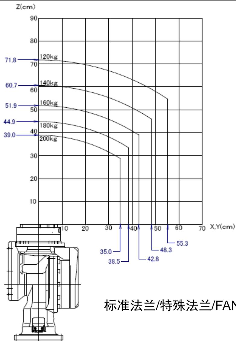
标准法兰/特殊法兰/FANUC法兰
